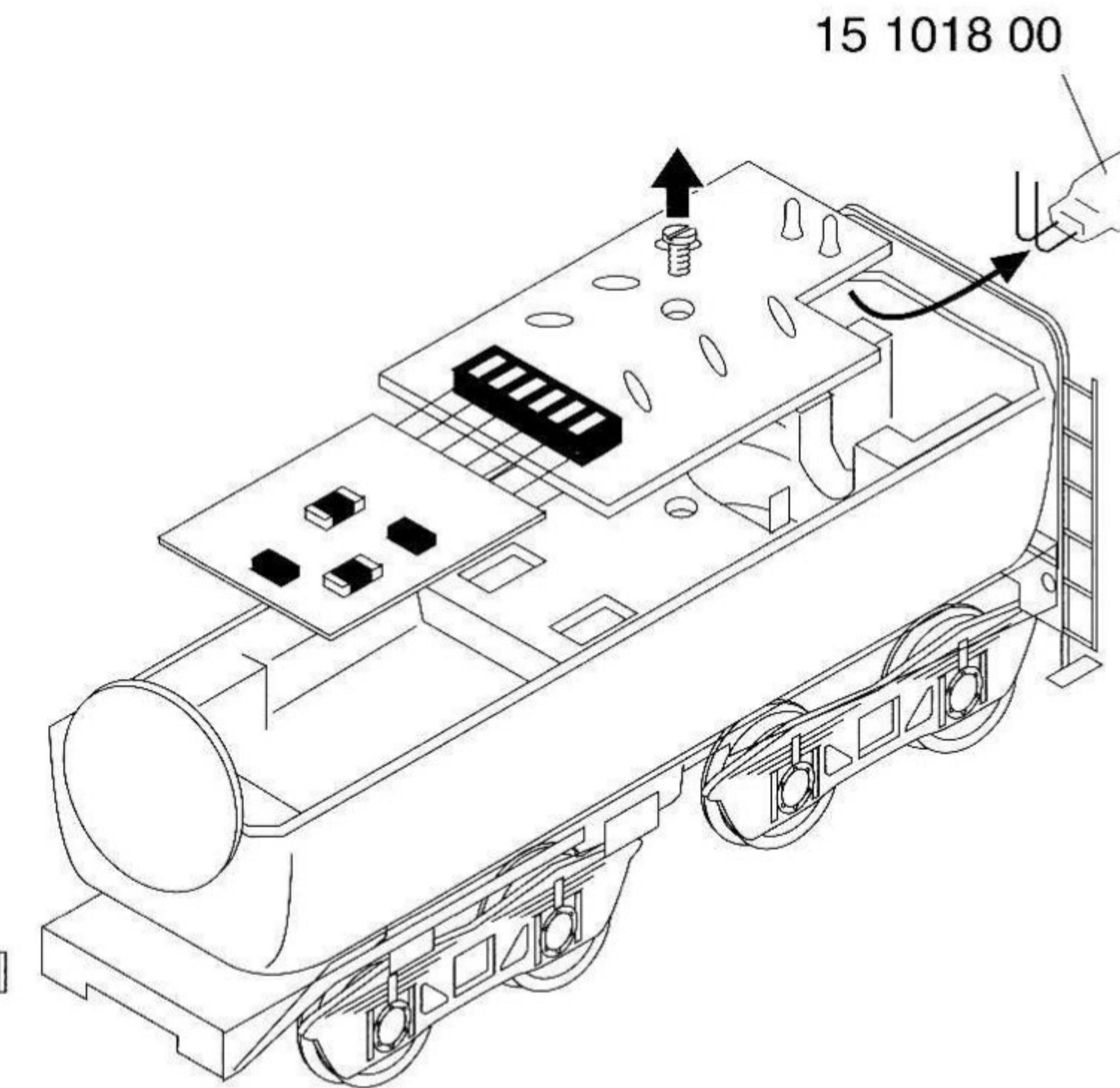
Einbau Selectrix Lokdecoder
